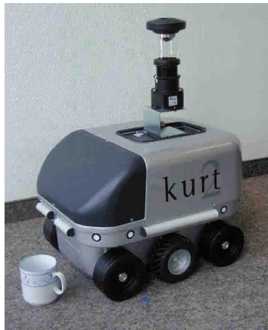
Abbildung 6.1: Der Roboter Kurt II mit aufmontierter Kamera
