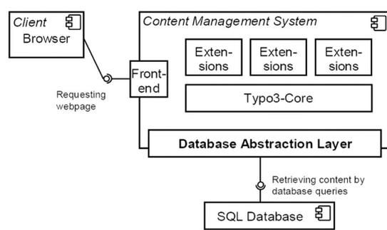
Abbildung 3: Modulare Architektur von Typo3 als UML-Komponentendiagramm
