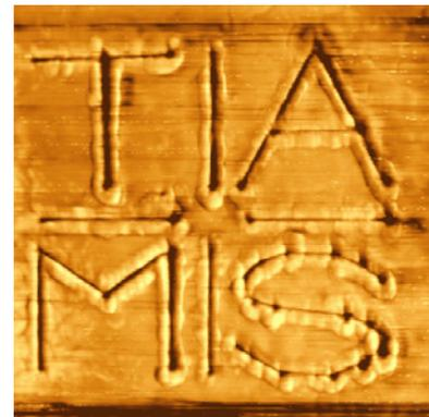
Abbildung 8: TAMS-Logo mittels Rasterkraftmikroskop in eine Au-Probe im autonomen Modus eingegraben. Abmessungen:  $7\mu\text{m} \times 7\mu\text{m}$ , Linienbreite ca. 120 nm, Tiefe ca. 15 nm.
