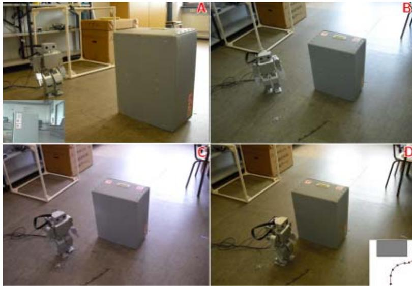
Abb. 5 Kollisionserkennung und Vermeidung mit dem humanoiden Roboter Hoap 2
