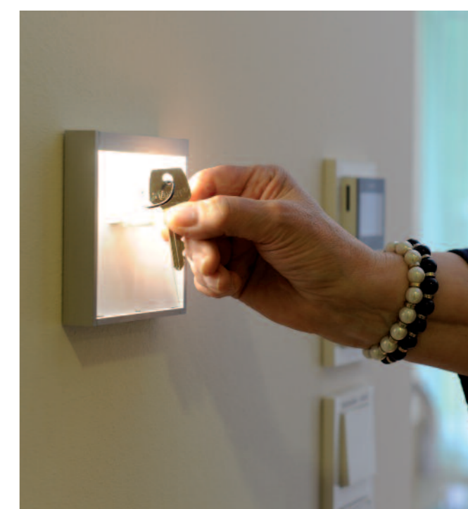
Schlüsselerinnerung: Beim Verlassen der Wohnung erinnert ein optisches oder akustisches Signal den Bewohner daran, seinen Schlüssel mitzunehmen.
